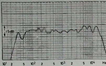
Bild 5. Schalldruckverlauf in Achsenrichtung des Lautsprechers
